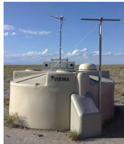
FIG. 21.3 – Détecteur EASIER MHz installé sur une cuve du réseau de surface de l'observatoire Pierre Auger
