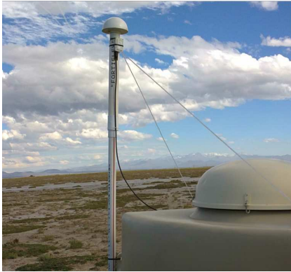
FIG. 21.7 – Détecteur EASIER GHz installé sur une cuve du réseau de surface de l’observatoire Pierre Auger. L’antenne au sommet du mat est protégée par un radome.
