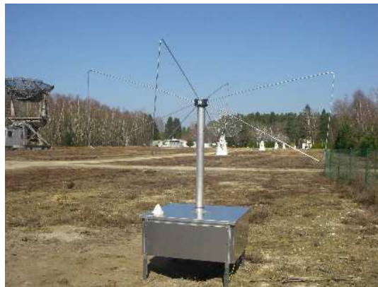
FIG. 6.2 – L'antenne "papillon" à l'Observatoire de Nançay. La troisième configuration de l'expérience CODALEMA est composée de 34 antennes autonomes (60 à la fin de l'année 2012), couvrant une surface d'environ 1km 2 , 4 fois plus grande que celle de la configuration précédente.
